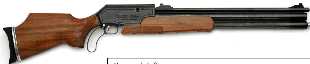
Koreansk luftgevær Kaliber 9 mm SHIN SUNG model Career Ultra Længde 108 cm Vægt 4,0 kilo Blyhaglenes hastighed ved munden 274 meter i sekundet
